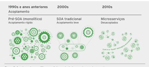
Figura 8. Acoplamento monolítico, arquitetura orientada a serviços e microsserviços
